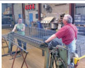
Betonstahl, Schneid- und Biegebetrieb, verlegefertig vorgeknottet,
